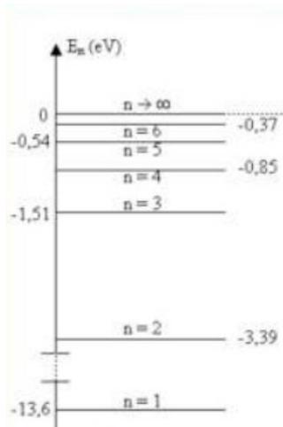
Le schéma nous indique que le photon porte une énergie de  $E_3 - E_2 = -1,51 - (-3,39) = 1,88 \text{ eV} = 3,0 \times 10^{-19} \text{ J}$
