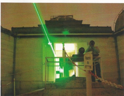
fig. 6 La lumière du laser a mis 3,66 \times 10^{-8} secondes, (c'est-à-dire 0,0366 millième de secondes) pour revenir jusqu'au détecteur.
